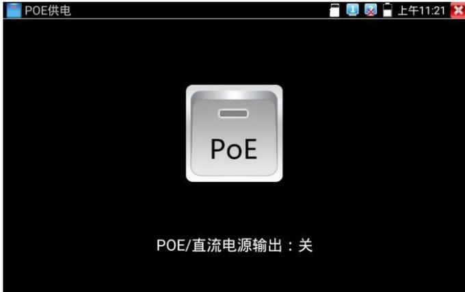
儀錶直流電源輸出開啟，退出電源輸出介面後，PoE電源處於開啟狀態，儀錶上面的菜功菜單條一直懸浮“48V已打開”，直到儀錶休眠或進入電源輸出功能介面點擊關閉電源輸出。
