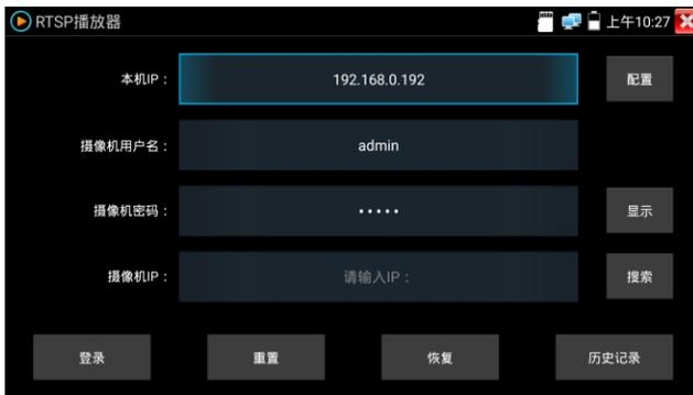
點擊“RTSP 位址”後面的搜索，選中掃描到的攝影機的 IP 位址。儀錶將掃描到網路攝影機的 RTSP 位址自動填入，客戶也可以手動填入已知 RTSP 位址。
