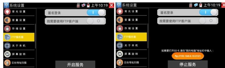
開啟FTP服務後，在PC機的“電腦”欄中輸入儀錶顯示的ftp位址（如：ftp://192.168.0.233:2121），PC電腦可方便的複製、粘貼檔，而不需要讀卡器來讀寫SD卡檔。
