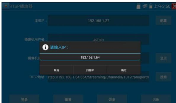
選擇顯示圖像的碼流類型，點擊確定可觀看圖像（當攝影機解析度大於 8K 的時候，可選用解析度較小的子碼流，此時可以流暢的觀看圖像）
