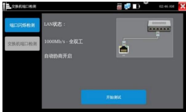
用於區分其它交換機在用端口，快速定位交換機端口。
