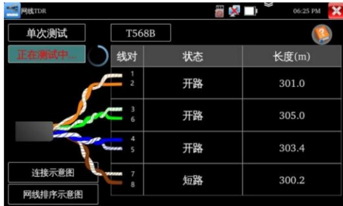
**單次測試和連續測試：**測試線纜狀態、長度，最長測試距離為 600 米。
