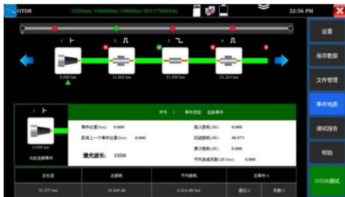
將光纖鏈路檢測結果可視化，光纖鏈路的長度、接頭類型、熔接點、熔接點或斷點等資訊以圖形化的形式呈現，更加簡單易懂。
