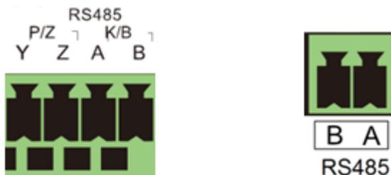
上左圖為 RS485 介面，Y、Z 用於控制快速球設備的介面(預留介面，暫不可用)，A 和 B 用於控制鍵盤接入的介面；上右圖中 A 和 B 為控制鍵盤的介面。(請注意!! A 為正極，B 為負極，錯誤接線將造成快速球設備無法控制。)
