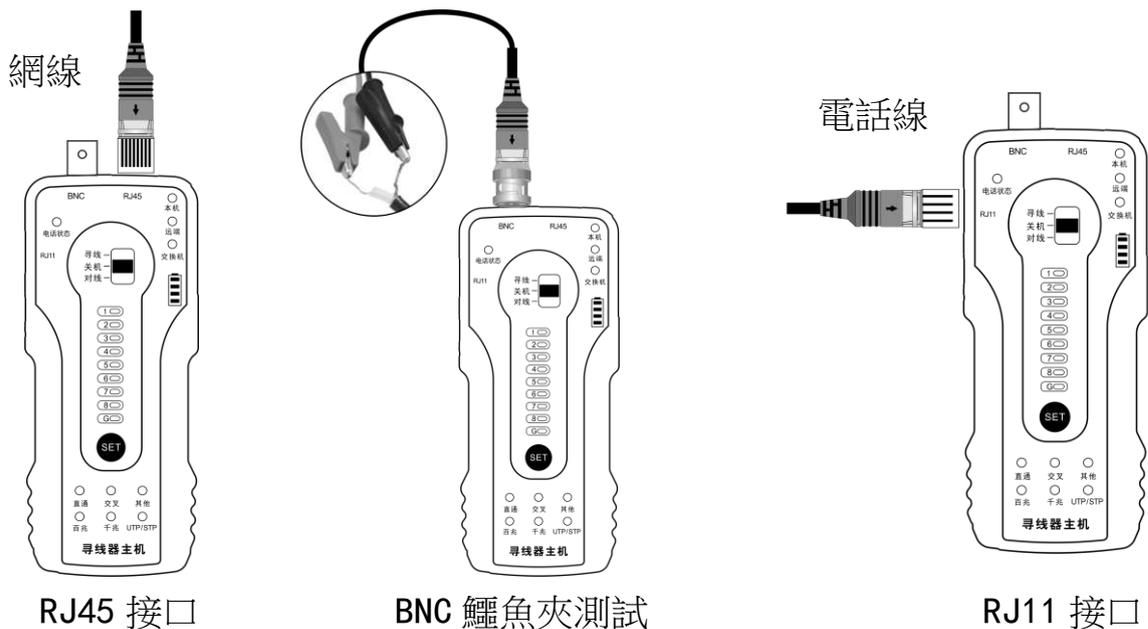
(1) 將主機開關按鍵撥至“尋線”檔位元，使用 SET 切換模式普通/遮罩模式。“UTP/STP”指示燈亮綠燈為普通模式，亮紅燈為遮罩模式，遮罩模式用於帶遮罩網線尋線。將尋線器（接收端）開機，可進行尋線。
